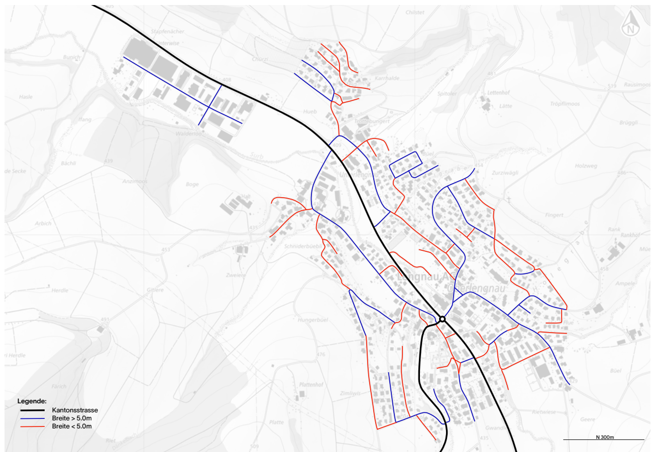
Abbildung: Einteilung der Strassen in Lengnau in zwei Klassen. Blaue Strassenabschnitte haben eine Fahrbahnbreite von 5,0m oder mehr, rote Strassenabschnitte sind weniger als 5,0m breit und nicht zum Parkieren im Strassenraum geeignet.
